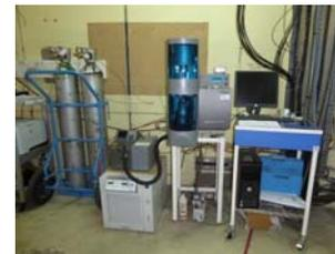
Processus d'oxydation thermique sous vapeur d'eau
